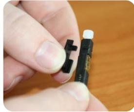
Vergewissern Sie sich, dass die Verriegelung auf der Unterseite des Steckers fest sitzt, indem Sie diese mit dem Daumen festdrücken. Der „Aktivierungs-Knopf“ muss komplett geöffnet sein.
